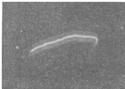
Fig. 7. Beginn der Funkenentladung. Dauer \frac{1}{500} Sek. 4 malige Vergrößerung der Filmbilder.
